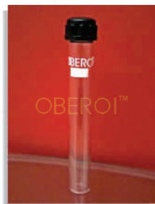
**Centrifugal Tube Conical Bottom Plain**
